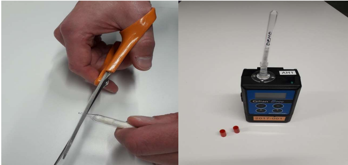
Kuva 1. XAD-putken katkaiseminen ja liittäminen pumppuun
