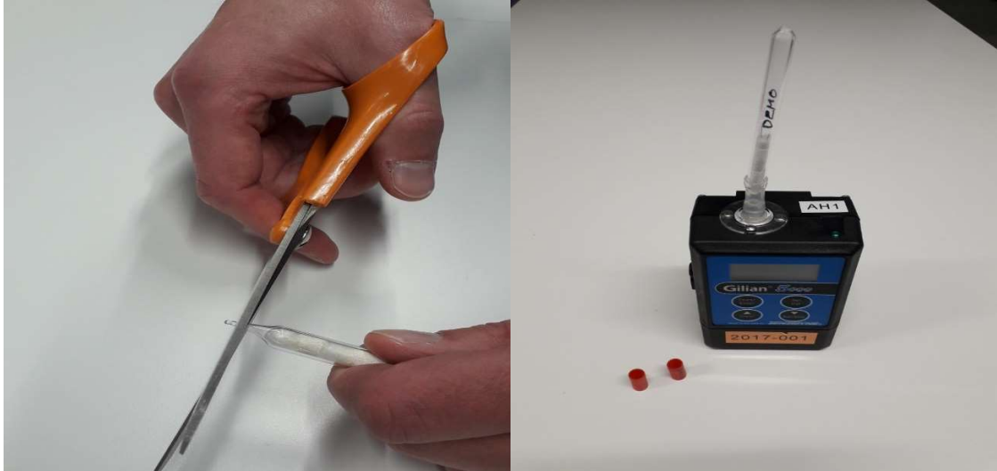
Kuva 1. XAD-putken katkaiseminen ja liittäminen pumppuun
