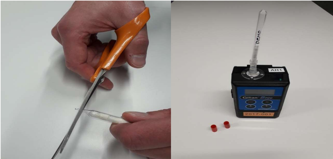
Kuva 1. XAD-putken katkaiseminen ja liittäminen pumppuun
