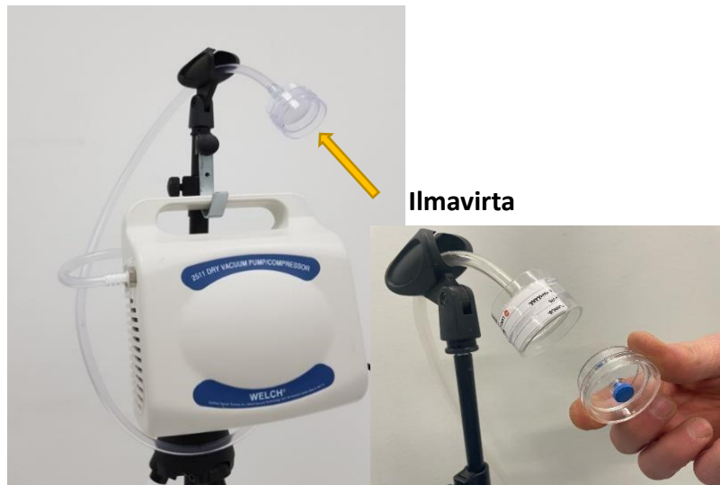
Kuva 3. Welch-pumppu ja läpinäkyvä Ø 37 mm:n suodatin. Irrota kapselista sinikorkkinen inlet-osa.
