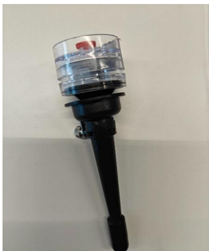
Kuva 3. Keräin liitetty sykloniin tiiviisti
