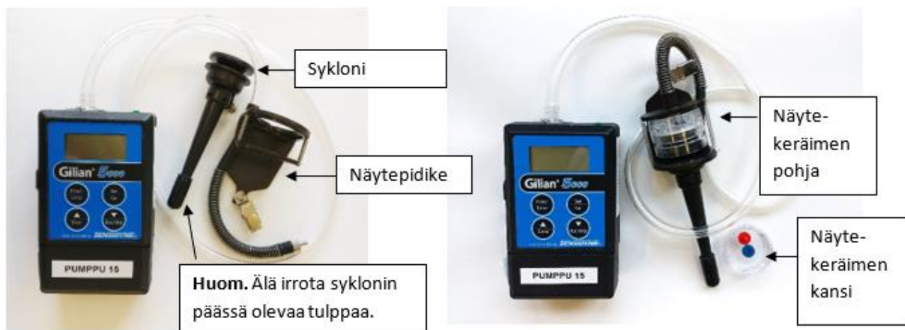
Kuva 1. Vakiovirtauspumppu, näytepidike, näytekeraimin ja sykloni alkutilanteessa sekä kasattuna
