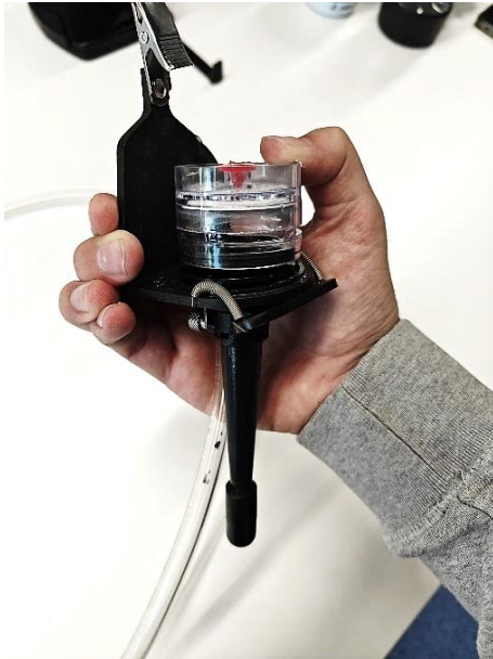
Kuva 4. Sykloni asetettuna näytepidikkeeseen.
