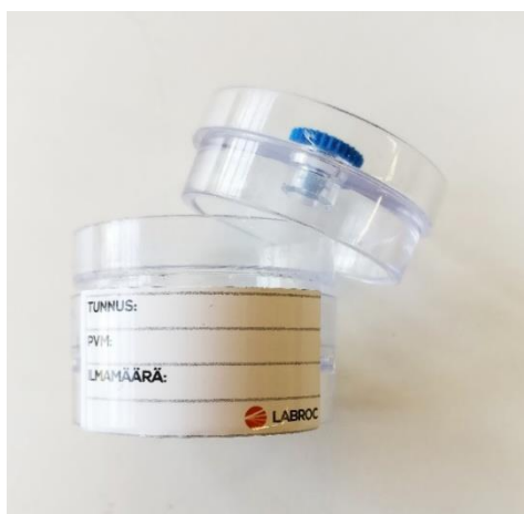
Kuva 2. Näyttekeräimen kannen aukaisu ennen sykloniin liittämistä
