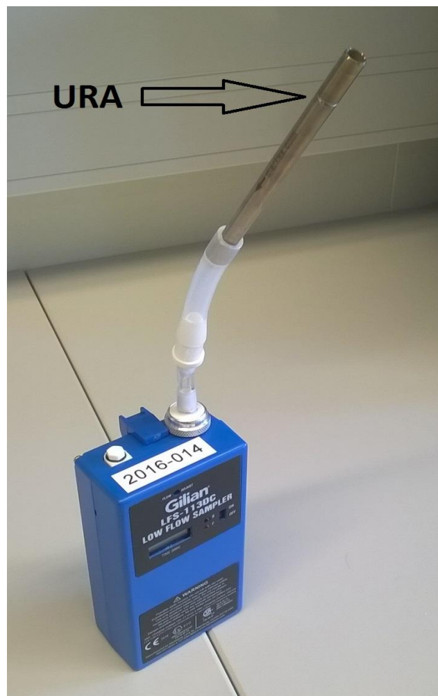
Kuva 3 Näytteenotossa ura pumpusta poispäin.
