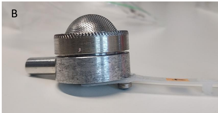
Kuva 4. Siiviläkupu tuntuu olevan kiinni, mutta kuvassa A, kupu on väärillä jengoilla. Kuvassa B kupu on oikein kiinnitetty.
