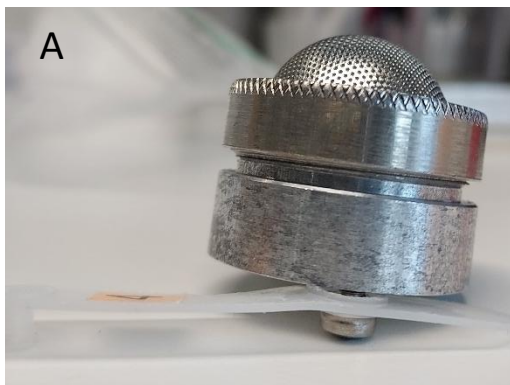
Kuva 4. Siiviläkupu tuntuu olevan kiinni, mutta kuvassa A, kupu on väärillä jengoilla. Kuvassa B kupu on oikein kiinnitetty.
