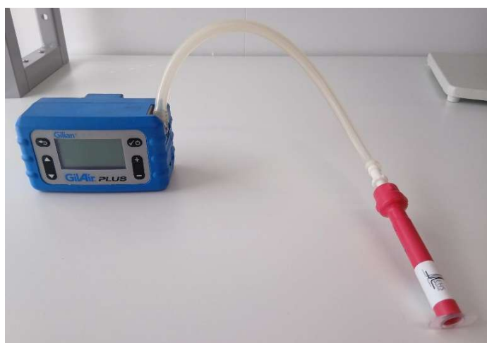
Kuva 4. Esimerkki näytteenotosta. Keräin on kiinnitetty adapterilla pumpun imuletkuun.
