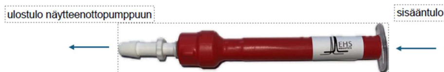
Kuva 3. Keräin, jossa on kiinni adapteri pumpun imuletkun liittämiseksi
