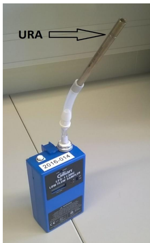
Kuva 3 Näytteenotossa ura pumpusta poispäin.
