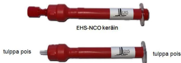
Kuva 1. Keräimen tulpat poistetaan ennen näytteenottoa.
